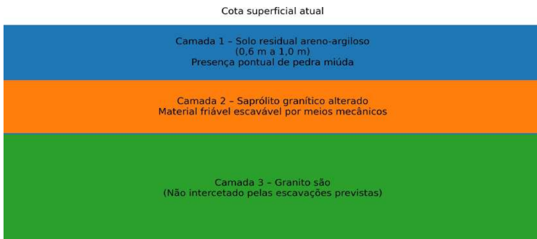
Figura 6: Esquema de perfil geológico no local de implantação do pavilhão 3
