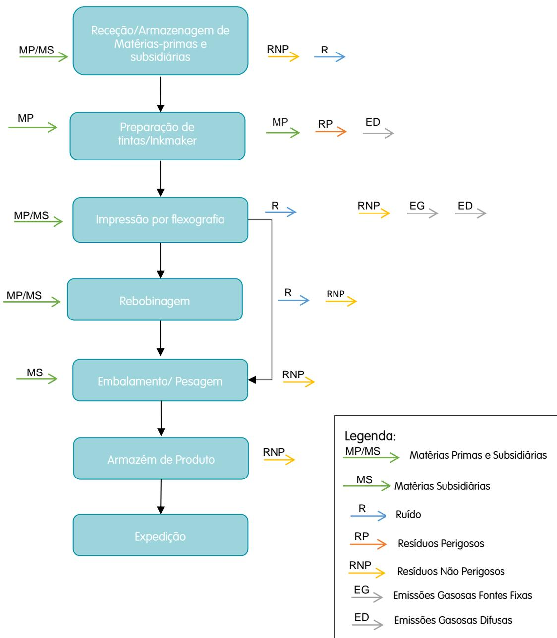
**Figura 1** – Diagrama do processo produtivo com indicação de entradas/consumos e saídas/emissões
