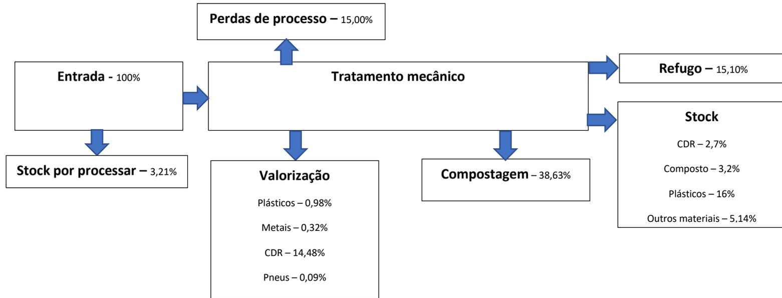
**Figura 9 Balanço de massas da UTMB.**
