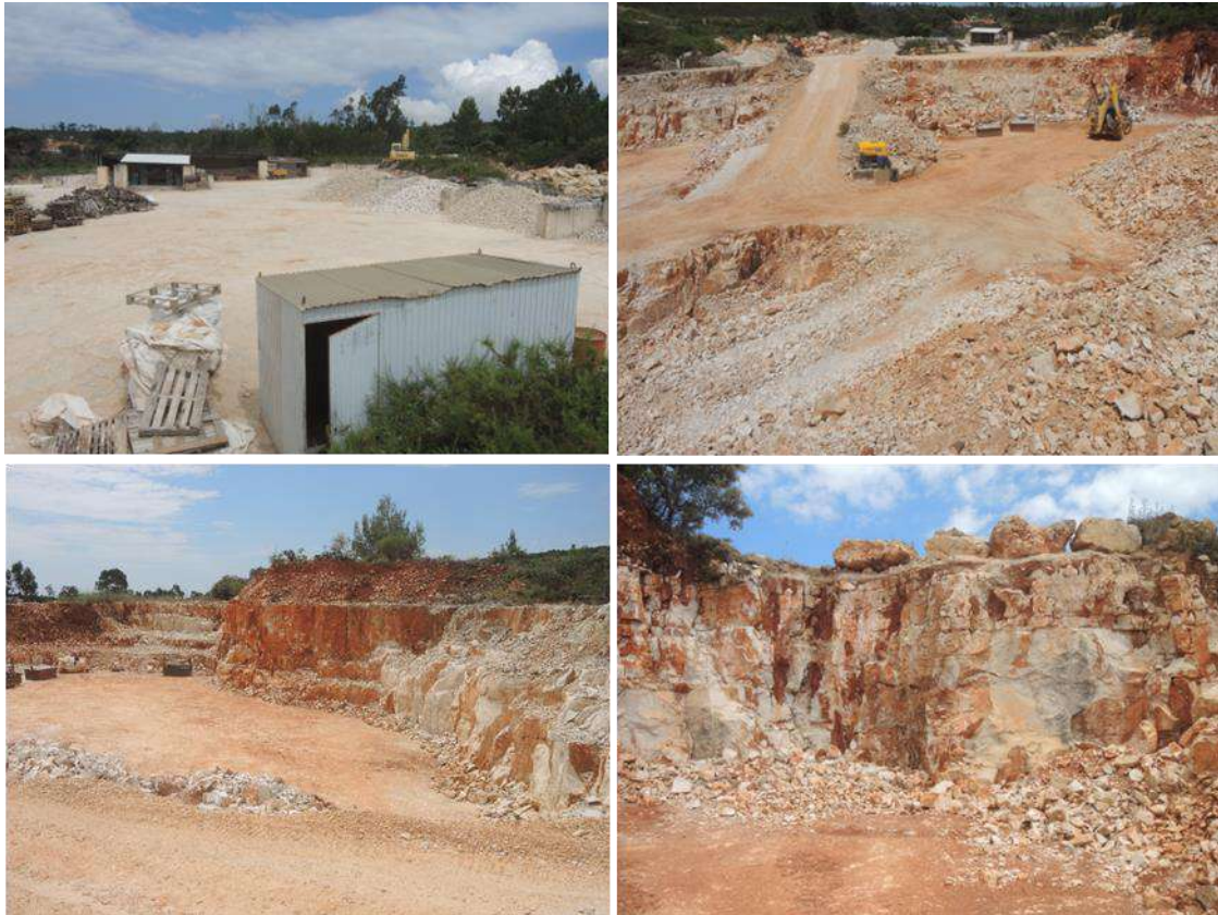
Figura 46 – Fotos 1 e 2 (cima esquerda, cima direita) – Vista geral da atual área do projeto licenciada; Foto 5 e 6 (baixo esquerda, baixo direita) – Bancada de exploração localizada junto ao limite SE e pormenor da fracturação de superfície.
