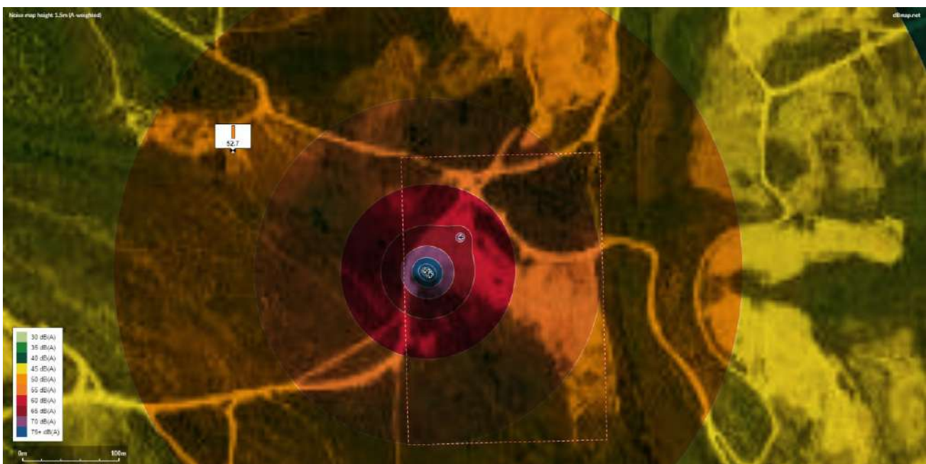
Fig. 10.1.1. – Lavra próxima de P1: perfis das linhas isófonas do ruído particular geradas pelas fontes mais ruidosas a operarem à cota zero
