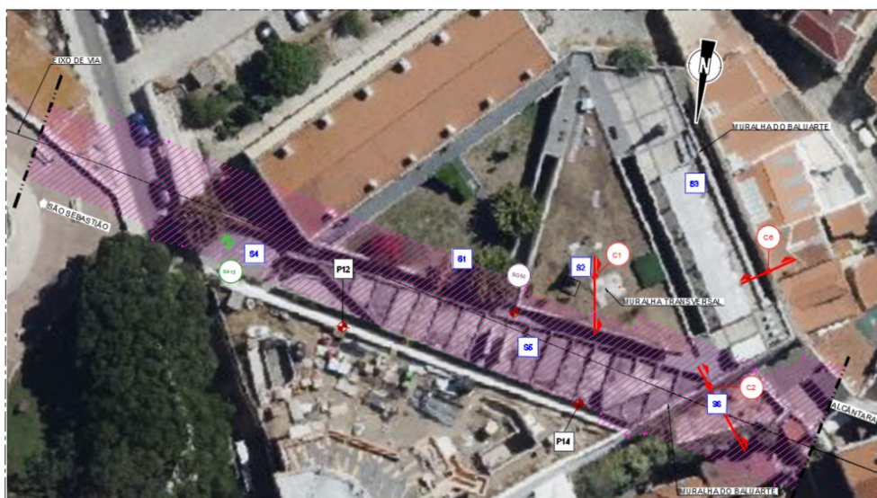
Figura 2 – Planta de localização das carotes executadas
