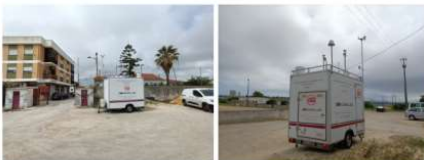
Figura 3 – Perspetiva da estação móvel de qualidade do ar durante as medições realizadas no local de medição P1.
