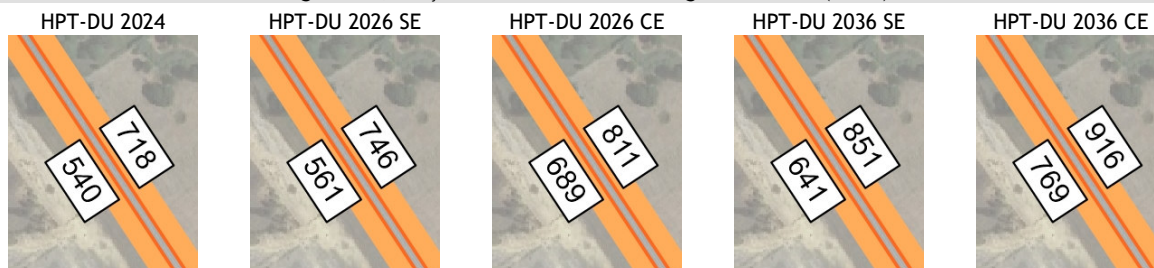
Figura 64 | Secção 1: Estimativas de tráfego na HPT-DU (uvl/h)
