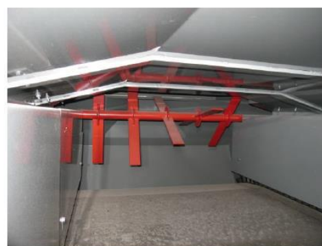
Figura 6. Exemplo (à esquerda) de doseador de tela com pré-tremonha, extração de fundo móvel e tambor nivelador (à direita) para controlo do nível de material sobre o doseador.
