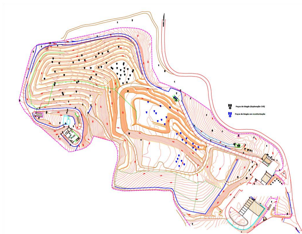
Figura 14 – Sistema Drenagem de Biogás do Aterro Sanitário de Urjais
