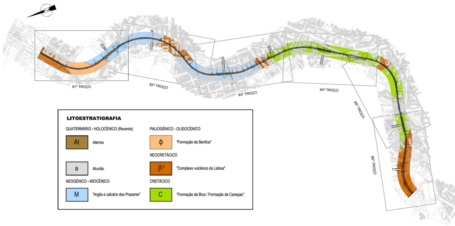
Figura 1 – Planta com traçado e cartografia geológica
