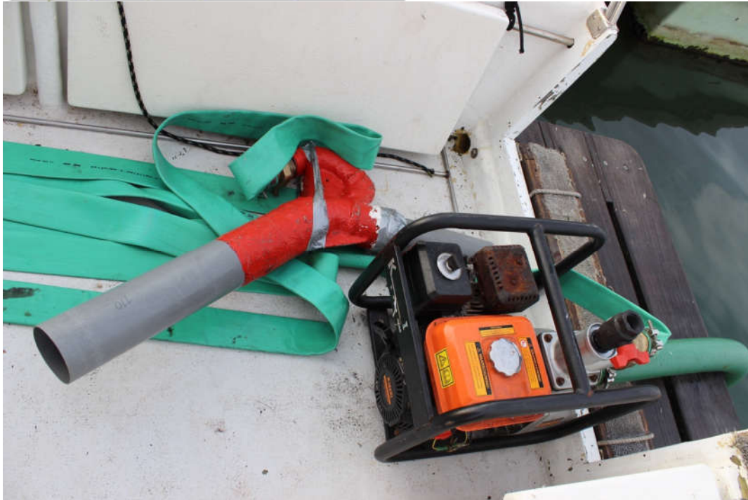
Figura 14 – Motobomba e mangueiras de sucção utilizada na realização das sondagens.
