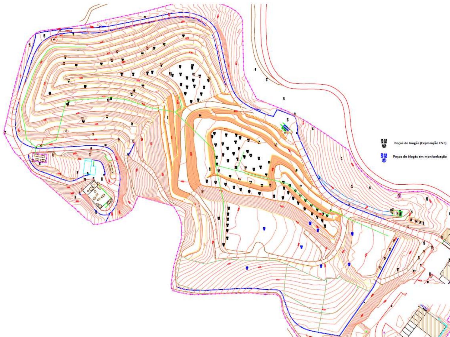
Figura 13: Sistema Drenagem de Biogás do Aterro Sanitário de Urjais.
