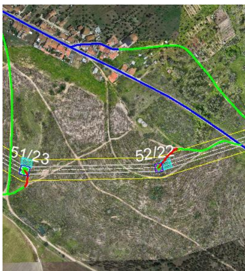
Figura 3.92 – Acessos aos apoios P51/23 e P52/22
