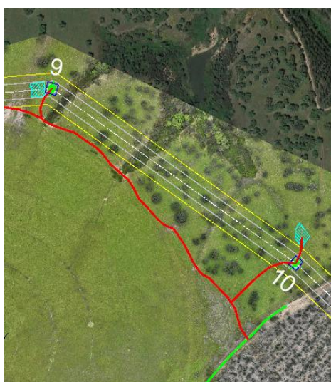
Figura 3.16 – Acesso aos apoios P9 e P10
