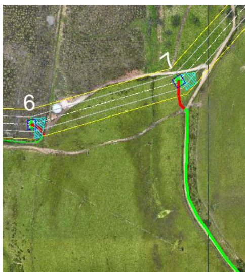
Figura 3.13 – Acessos aos apoios P6 e P7
