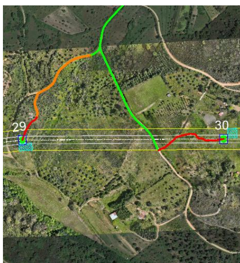
Figura 3.53 – Acessos aos apoios P29 e P30
