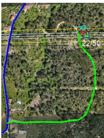
Figura 3.38 – Acesso ao apoio P22/50
