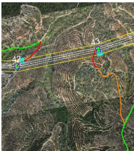
Figura 3.75 – Acessos aos apoios P42 e P43
