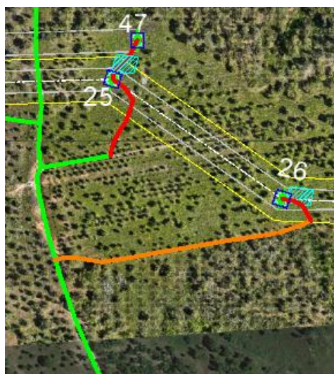
Figura 3.46 – Acessos aos apoios P25, P26 e P47
