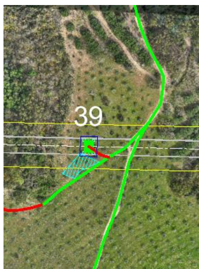
Figura 3.68 – Acesso ao apoio P39
