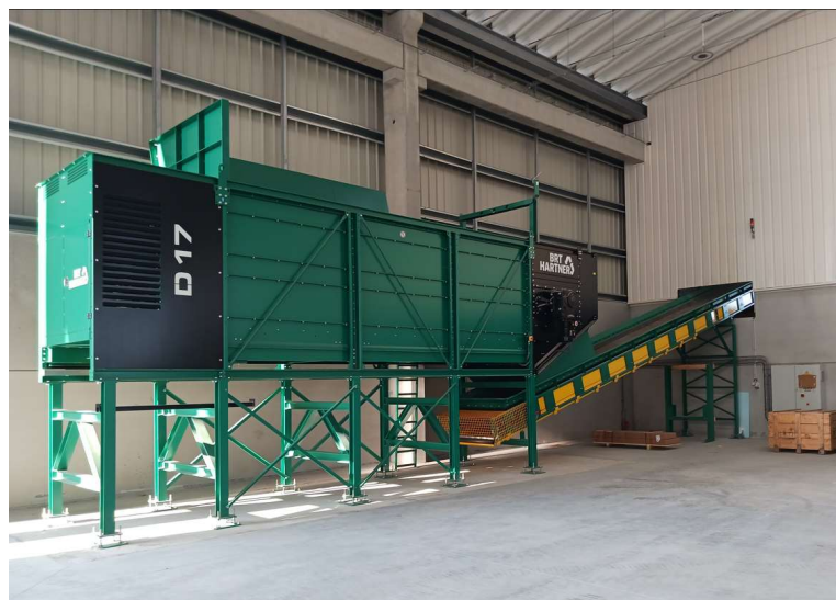
Figura 8. Alimentador da linha de afinação de composto
