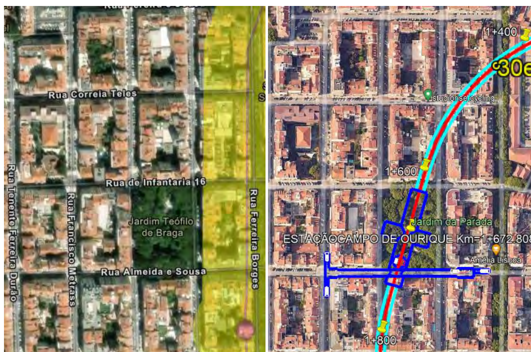
Figura 72 e 73 – Traçado do aqueduto e respetiva zona de proteção (Atlas do Património) e, à direita, ortofoto da área com a sobreposição do projeto e localização do local onde o futuro túnel se cruzará com o aqueduto (EP30e).
