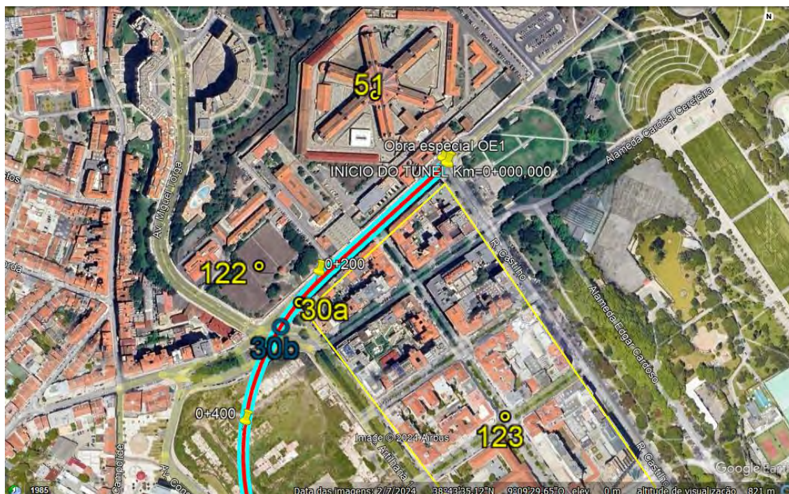
Figura 3 – Ortofoto (Google Earth) com implantação do projeto entre o Km 0+000 e 0+400 e elementos patrimoniais identificados, embora o assinalado a azul se situe num local onde a profundidade do túnel será superior a 25 metros.
