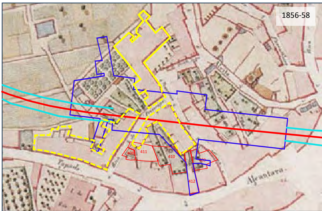
Figura 221 - Zona A com as demolições previstas no EP A assinaladas a vermelho sobre planta de 1856-58 de Filipe Folque (Lxi, cartografia histórica): a linha amarela contínua tracejada corresponde a áreas demolidas para a abertura do acesso à Ponte 25 de Abril.
