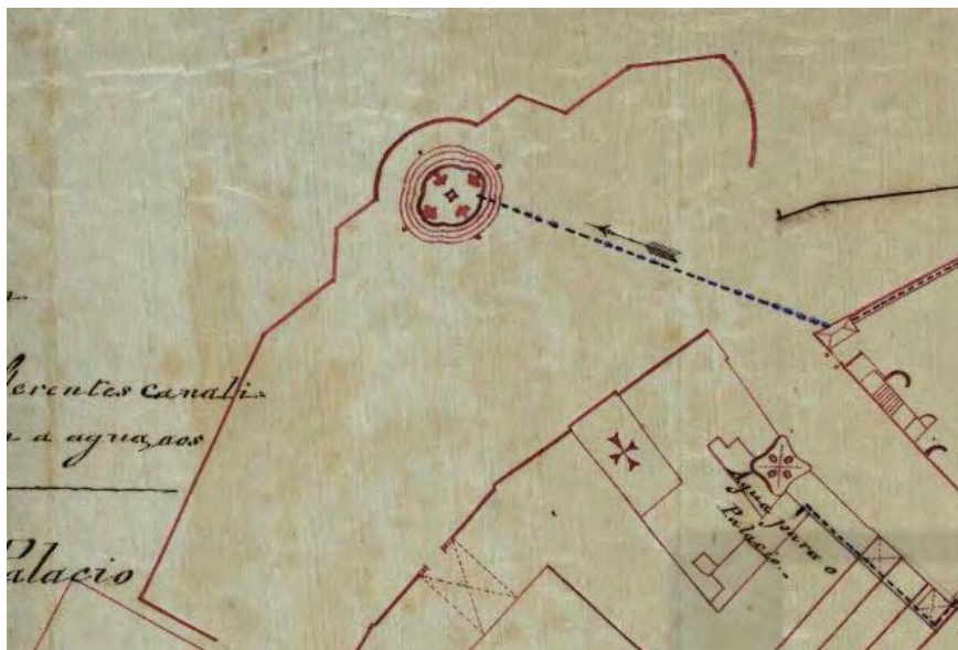
Figura 185 – (EP030i) Extrato da Planta dos aquedutos (...) do Palácio das Necessidades (PT/TT/CR/007-008/00219). A seta assinala a ligação à fonte.
