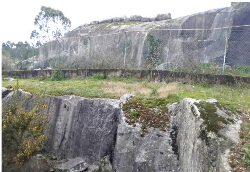
Figura 28 – Observação de maciço granítico pouco alterado a rocha sã, em que se verifica a presença de descontinuidades fechadas e fraturação F1-F2: estação geológica #1.
