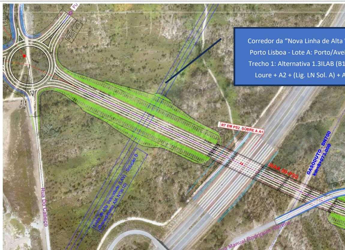
Figura 6.4 – Intersecção do ERAA com a Solução B integrada no Corredor da “Nova Linha de Alta Velocidade Porto Lisboa - Lote A: Porto/Aveiro (Oiã)” - Trecho 1: Alternativa 1.3ILAB (B1 + ILBA S.J. Loure + A2 + (Lig. LN Sol. A) + A3 + ILAB Loureiro) em planta
