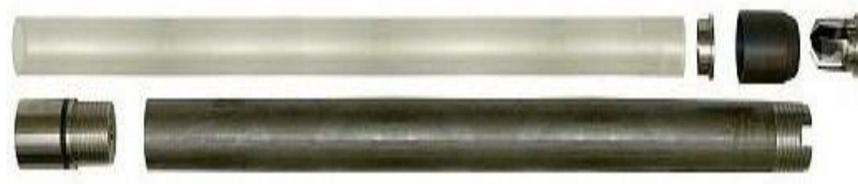
Figura 8 – Amostrador de cravação “direct-push”, com “liner” translúcido
