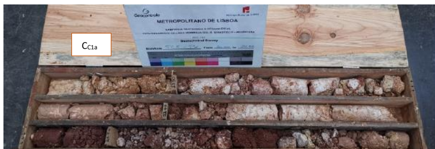
Figura 5.11 - Argila margosa e/ou margas argilosas esbranquiçadas a amareladas.
