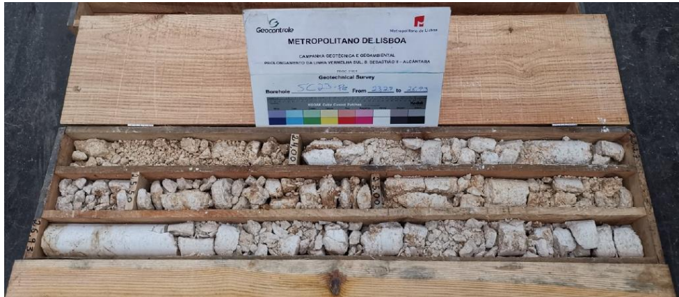
Figura 2.4 – Calcário Fendilhado observado na sondagem SC23- Pz, a partir dos 25.5 aos 28.0m.
