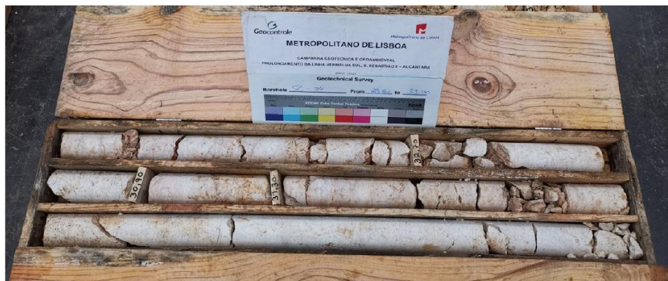
Figura 2.5 - Calcário Fendilhado observado na sondagem SC34- Pz, a partir dos 30.90 aos 33.0m.
