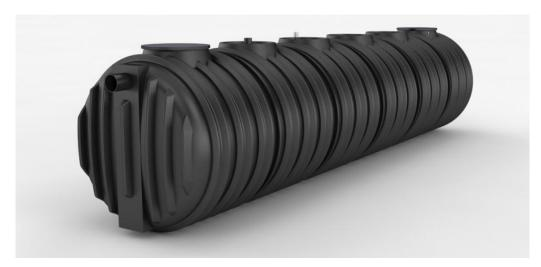
Os Separadores de Hidrocarbonetos ECODEPUR®, Gama DEPUROIL® são Classe 1 de acordo com a norma EN858, apresentando núcleo de coalescência e válvula obturadora de segurança. Os Separadores de Hidrocarbonetos, Gama DEPUROIL®, permitem obter um efluente final com concentração de hidrocarbonetos inferior a 5 mg/l, nas condições de teste da referida norma, dando deste modo cumprimento às exigências de descarga estabelecidas na legislação vigente, nomeadamente no Decreto-Lei 236/98 de 1 de Agosto.
