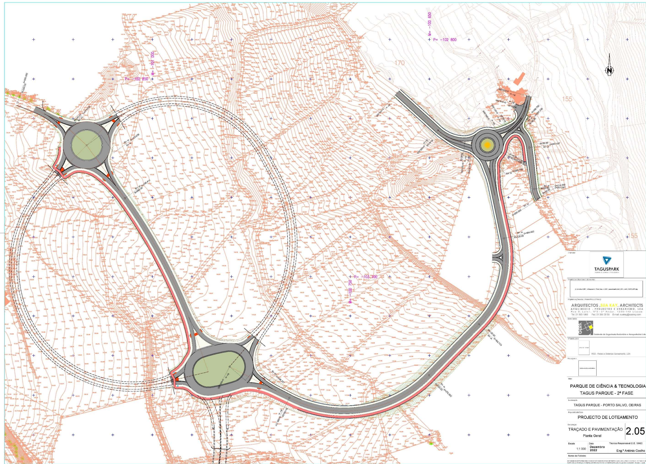
Figura 35 - Planta geral do traçado de rede viária alternativo, escala 1:1 000. Fonte: João Coelho, 2022. Fonte: JPQV 2021
