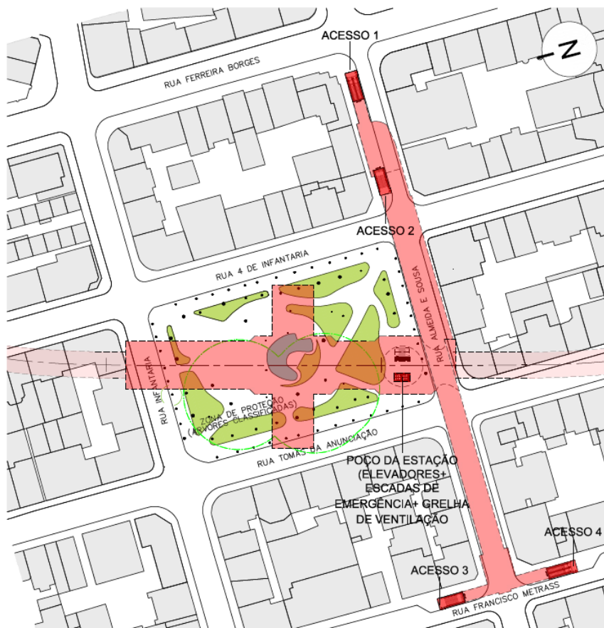
Figura 16 – Estação Campo de Ourique – Implantação conforme Anexo Z das ‘bocas de acesso’ à superfície (E1/E2/E3 e E4)
