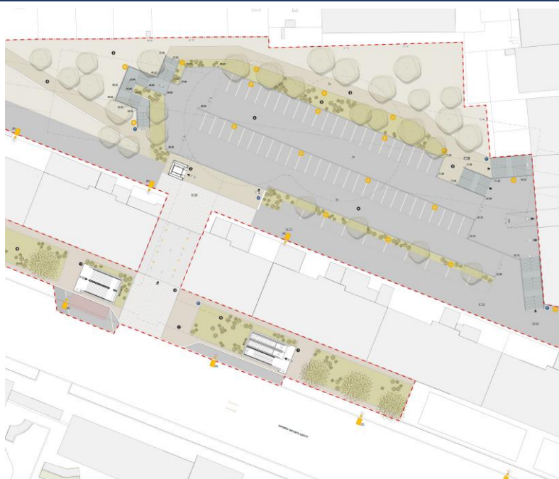
Figura 23 – Excerto do desenho do volume 3 do tomo V, de Arquitetura Paisagista, assegurando a reposição de 62 lugares, e de acordo as premissas da planta de superfície da envolvente à EIS (desenho ML 123443)
