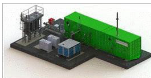
Figura 4 – Vista do arranjo típico dos equipamentos de upgrading
