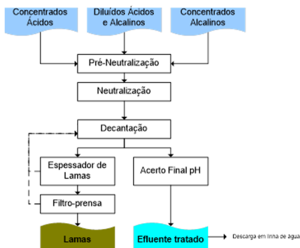
Figura 4: Esquema de princípio da ETAR.
