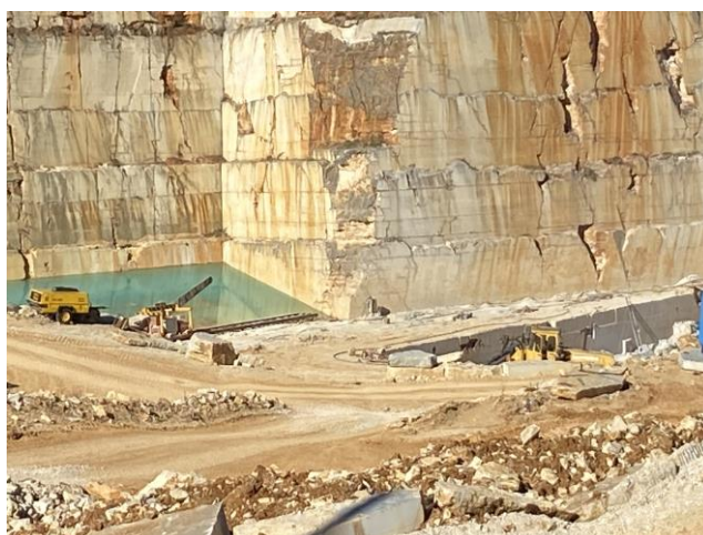
Foto 3 – Vista parcial do fundo da corta de exploração, com a formação em rebaixo de um recetor natural de águas pluviais para utilizar nos trabalhos de desmonte.
