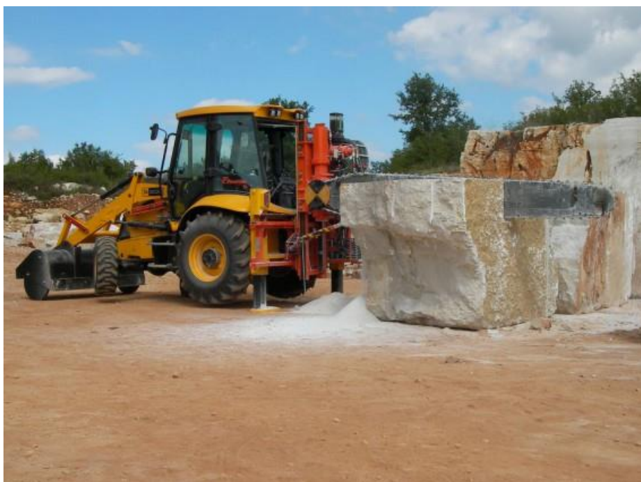
Figura 14 - Corte pelo serrote de lança mais curta para aparelhar o bloco.
