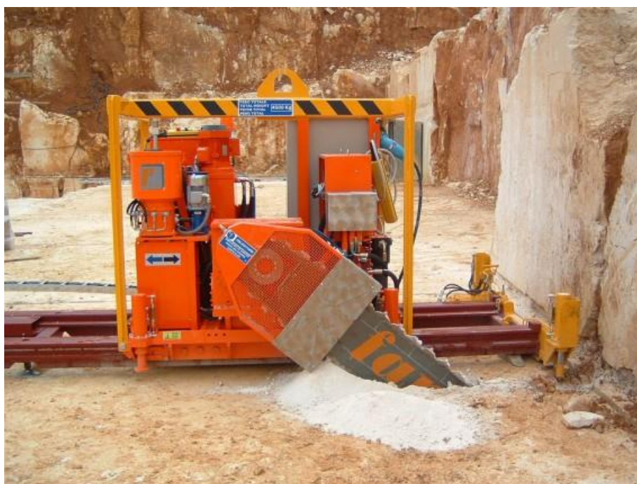
Figura 13 – Corte em bancada pelo serrote de lança mais comprida. Corte lateral da face perpendicular à face livre.
