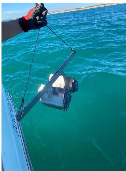
Figura 18. Draga Van Veen usada para amostragem de superfície.
