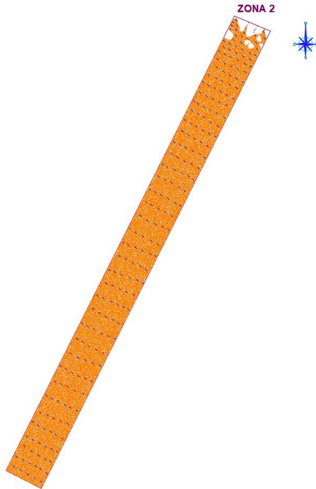
Figura 9. Sedimentos não consolidados do tipo areia grossa com ondulações mapeados com sonar de varredura lateral na zona 2.
