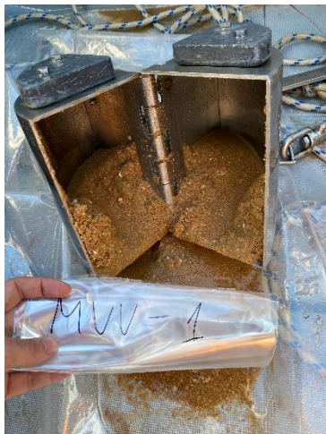
Figura 19. Amostra colhida com draga Van Veen.
