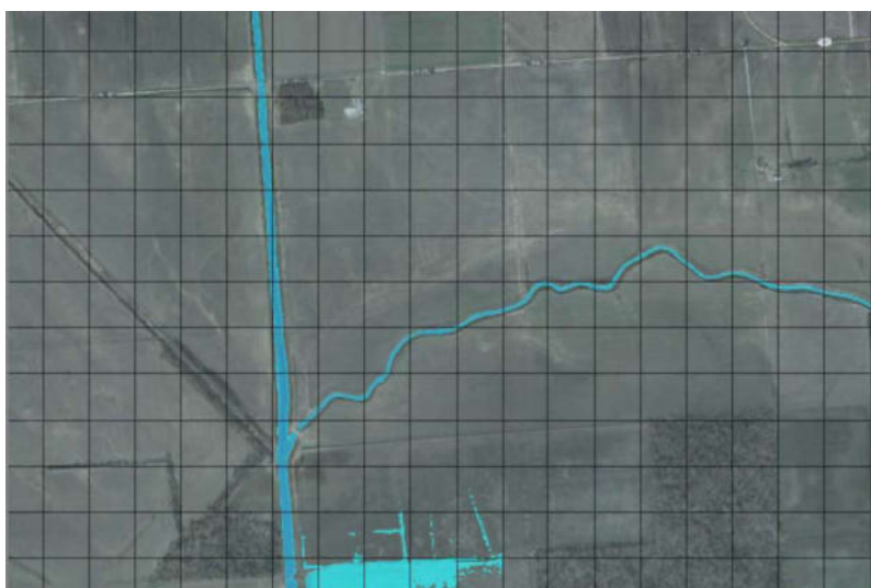
Figura 22 - Exemplo de canais pequenos circulando por células grandes.
