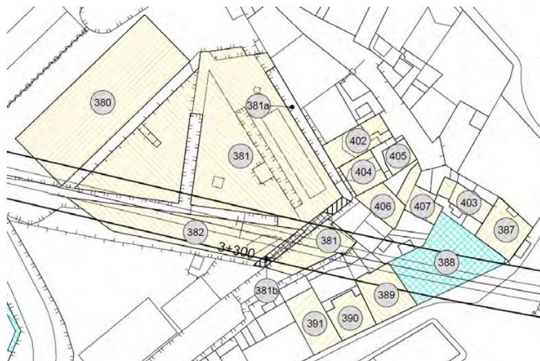
Figura 120 – Identificação do edificado a demolir – interferências 380, 381 e 382
