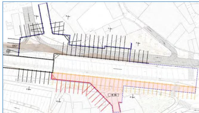
Figura 102 - Planta de Dimensionamento Contenção Provisória - 3ª Fase de escavação
