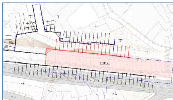
Figura 101 – Planta de Dimensionamento Contenção Provisória – 2ª Fase de escavação
