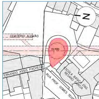
Figura 22 – Implantação do Poço de Ventilação PV215
