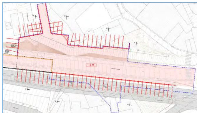
Figura 100 – Planta de Dimensionamento Contenção Provisória – 1ª Fase de escavação
