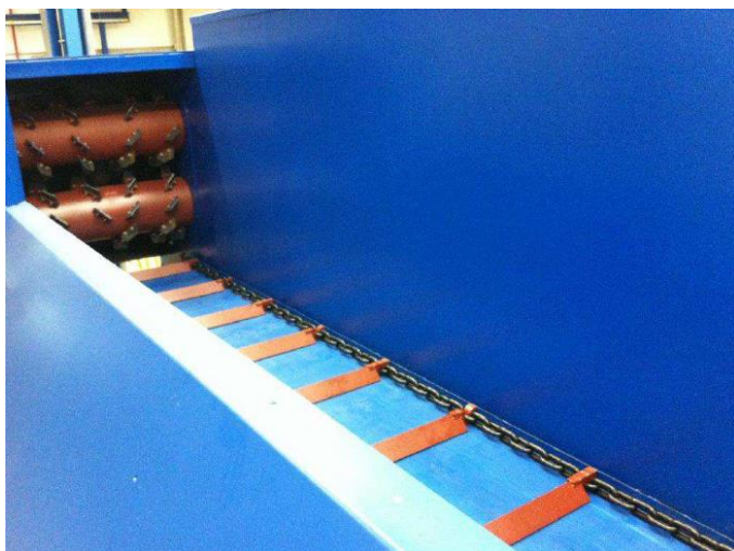
Figura 1- Exemplo do fundo de arrasto do tapete do misturador de bioresíduos.
