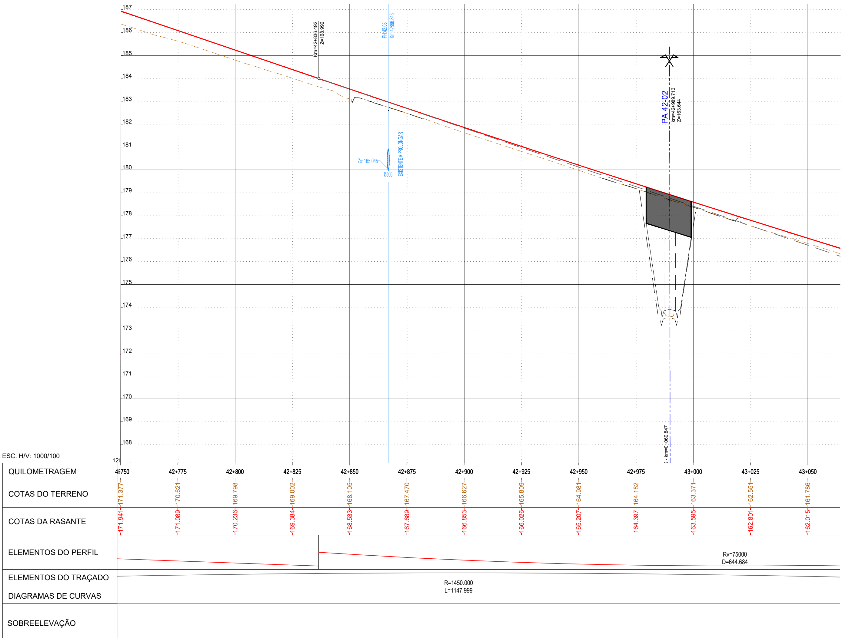
PERFIL LONGITUDINAL VIA PRINCIPAL ESC. H= 1:1000 V= 1:100
