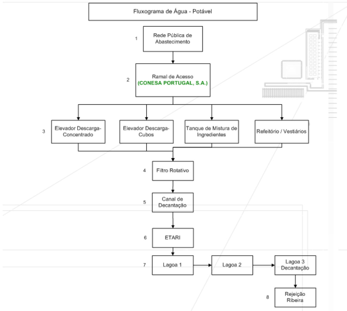
Figura 2.12 - Fluxograma da água potável (associada à captação da rede pública (AC3))
