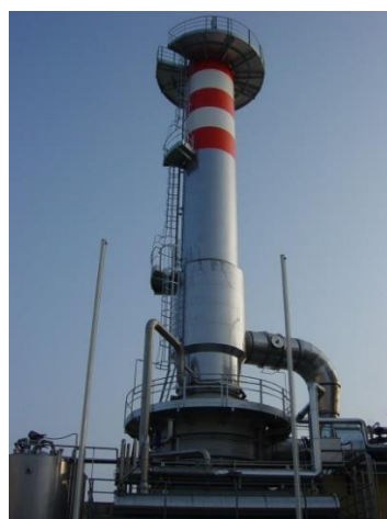
Figura 6- Evaporador a 4 efeitos por filme descendente “Apollo – 4FF”.
