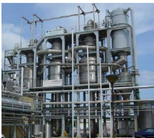
Figura 5- Evaporador a 3 efeitos Vénus T-120.
