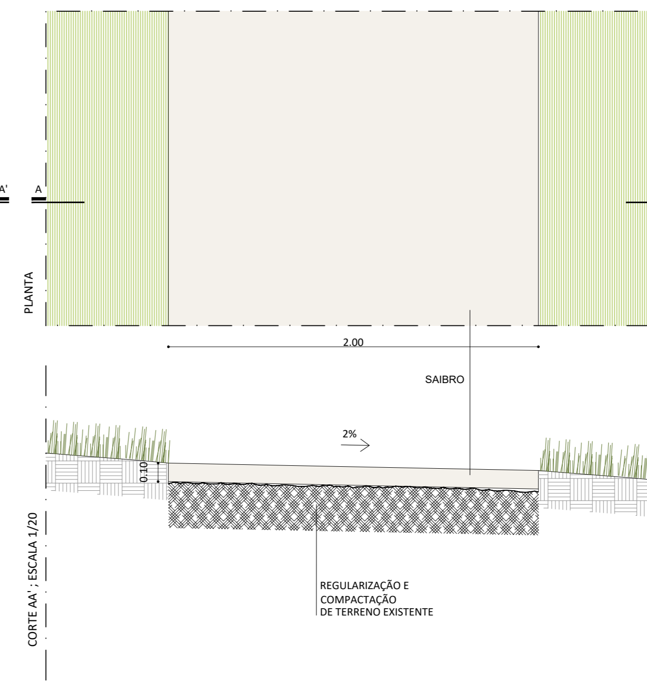
P06 TRILHOS SUL 2.0m - PAVIMENTO EM SAIBRO, SOBRE CAMINHO EXISTENTE
