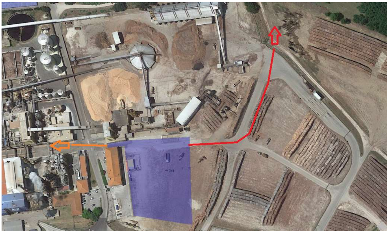
Figura 24 – Sistemas de drenagem da plataforma da nova central a biomassa (rede industrial — rede pluvial —)
