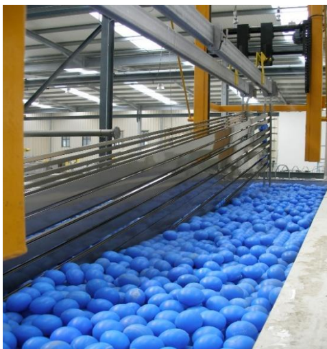
Figura 9. Banho de colmatagem.
