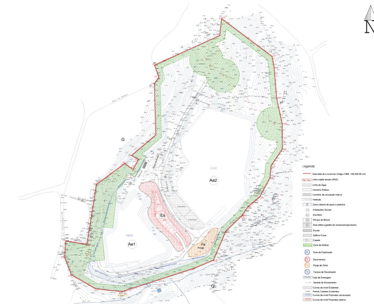
Figura 13: Extrato da Planta da Lavra final, incluindo a rede de drenagem, apresentada no Plano de Pedreira (sem escala).
