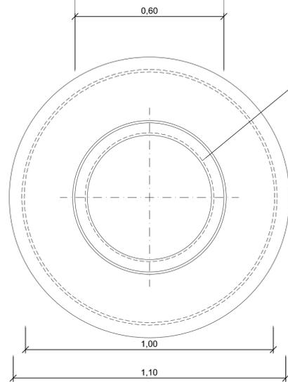
BASE DRENANTE PRÉ-FABRICADA EM BETÃO COM ORIFÍCIO PARA DRENAGEM DE LÍQUIDOS
