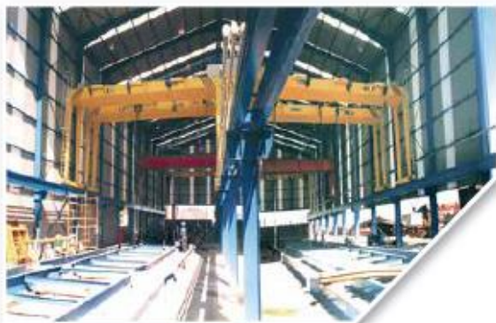
Pórtico bicarril Double girder gantry crane
