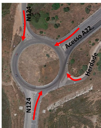
Figura 83 | Interseção 1, movimentos analisados
