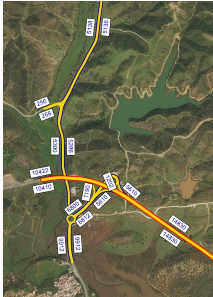
Figura 25 | Volumes de tráfego de veículos ligeiros em TMD na rede rodoviária futura – Ano Horizonte (2045) - Cenário Sem Intervenção
