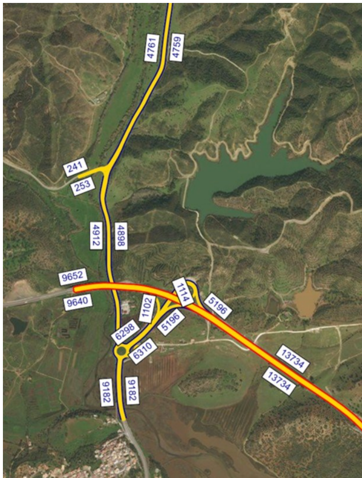
Figura 25 | Volumes de tráfego de veículos ligeiros em TMD na rede rodoviária futura – Ano Base (2029) - Cenário Sem Intervenção
