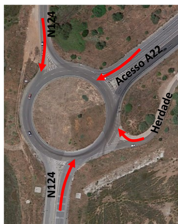
Figura 47 | Interseção 1, movimentos analisados
