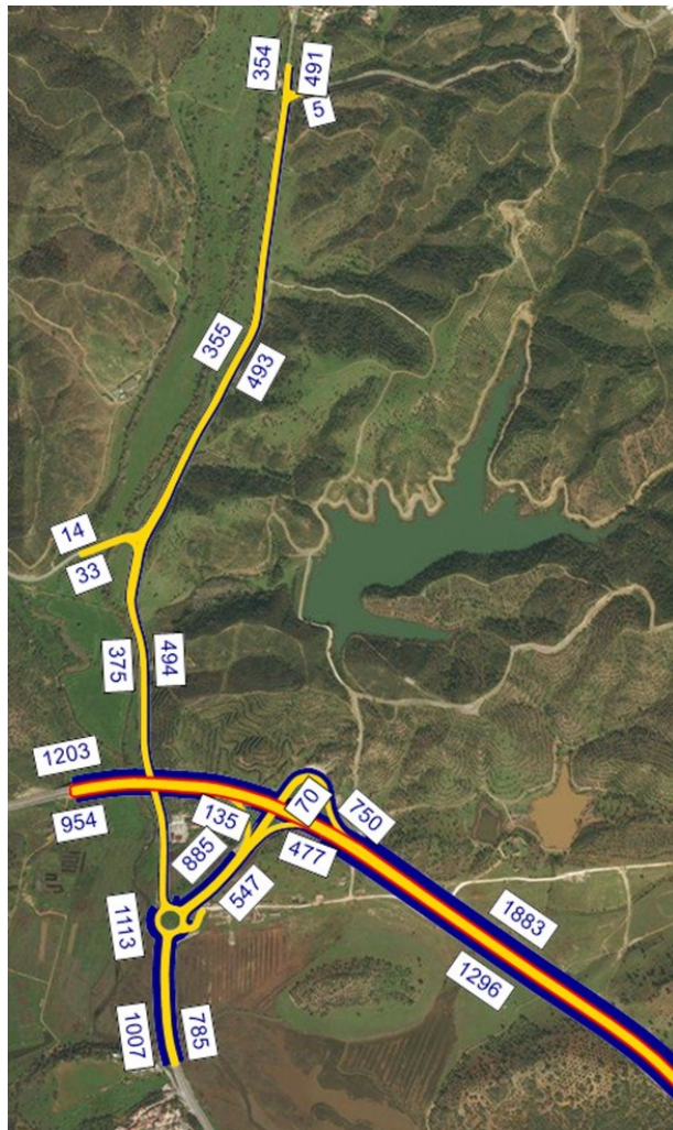
Figura 80 | Volumes de tráfego na rede rodoviária futura em uvle, HPT SAB – Ano Intermédio (2035)
