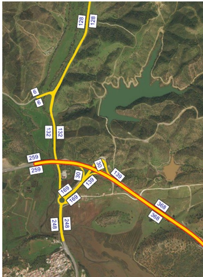
Figura 25 | Volumes de tráfego de veículos pesados em TMD na rede rodoviária futura – Ano Base (2029) - Cenário Sem Intervenção
