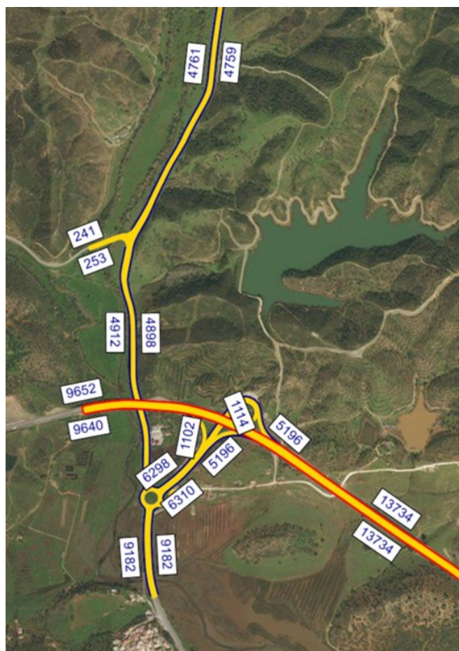
Figura 25 | Volumes de tráfego de veículos ligeiros em TMD na rede rodoviária futura – Ano Intermédio (2035) - Cenário Sem Intervenção
