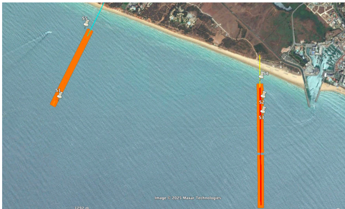
Figura 18 – Distribuição dos alvos de sonar nas áreas de levantamento geofísico e indicação das AID (laranja) e AII (vermelho)
