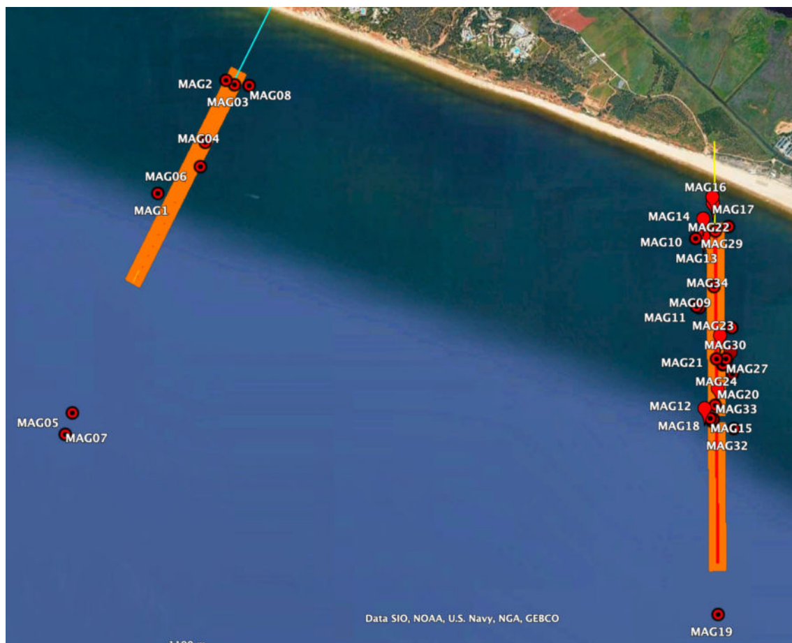
Figura 20 – Distribuição das anomalias magnéticas nos dois corredores estudados com a representação das áreas de incidência (laranja e vermelho)
