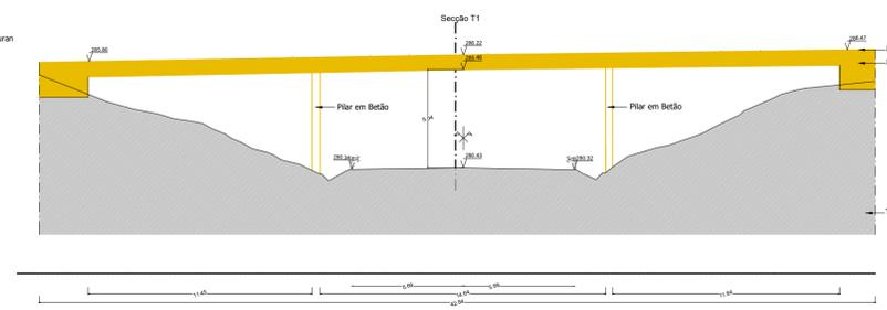
OBRA A DEMOLIR - CORTE LONGITODINAL
