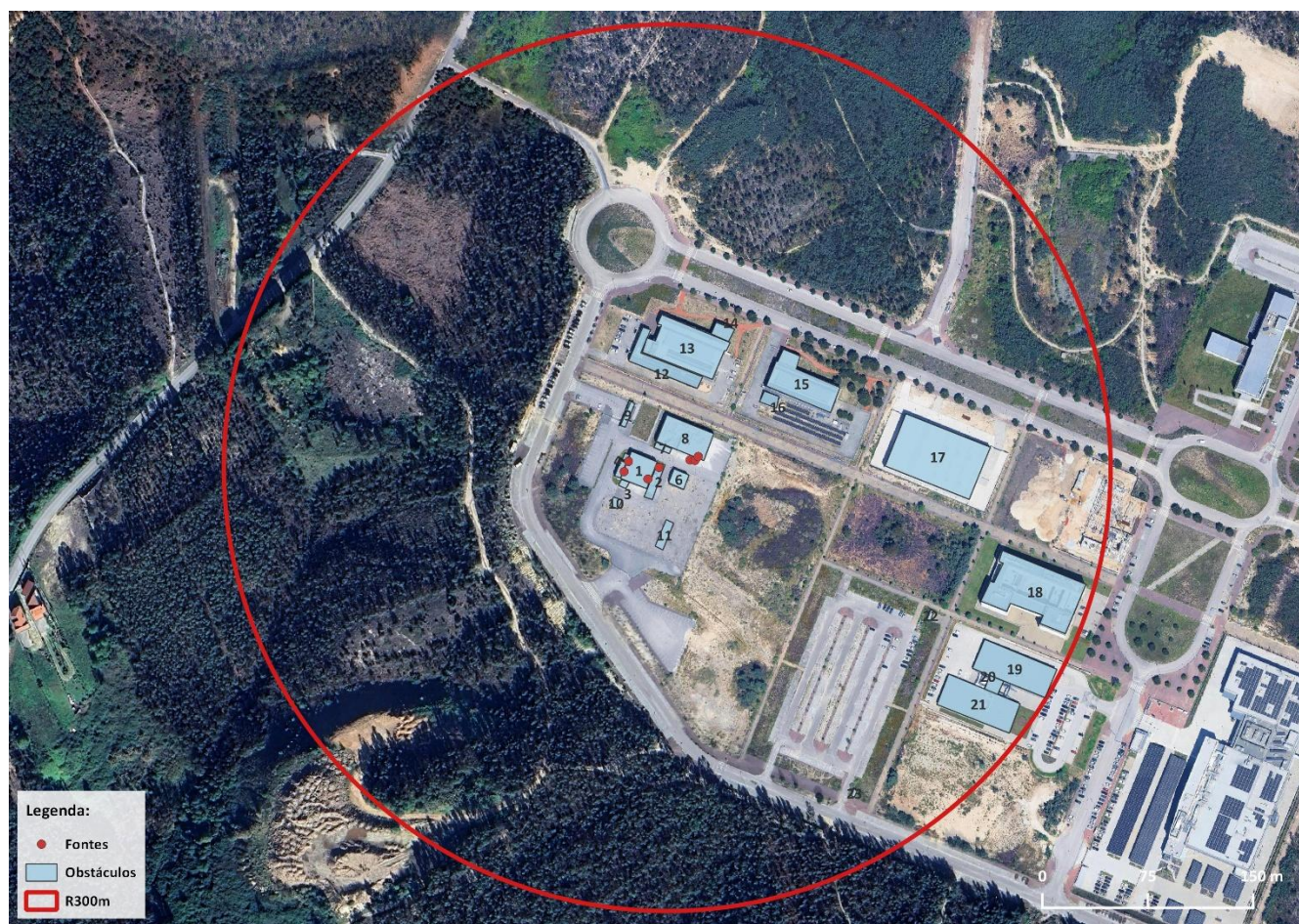
Figura II-1 – Apresentação dos obstáculos inseridos no raio de 300 metros, a partir das fontes em estudo, incluindo os edifícios da própria instalação (Imagem do ano 2025 do Google Earth ).
