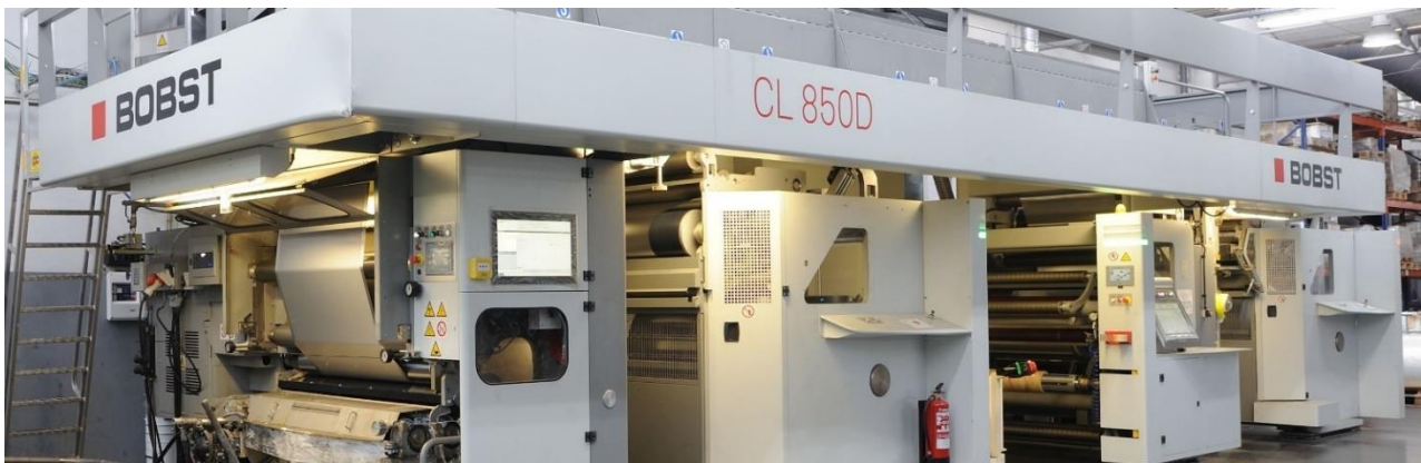
Figura 7 - Registo fotográfico de um equipamento de complexagem com solvente
