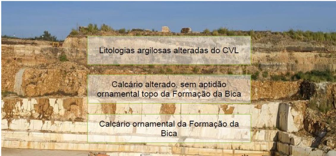
**Figura 7: Fotografia à pedreira "Baladinho1" onde é visível a geologia local da pedreira.**
