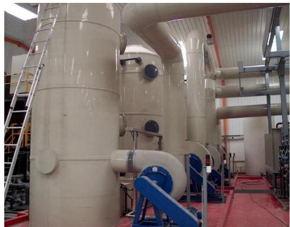
**Figura 6** – Perspetiva das torres de lavagem de gases
