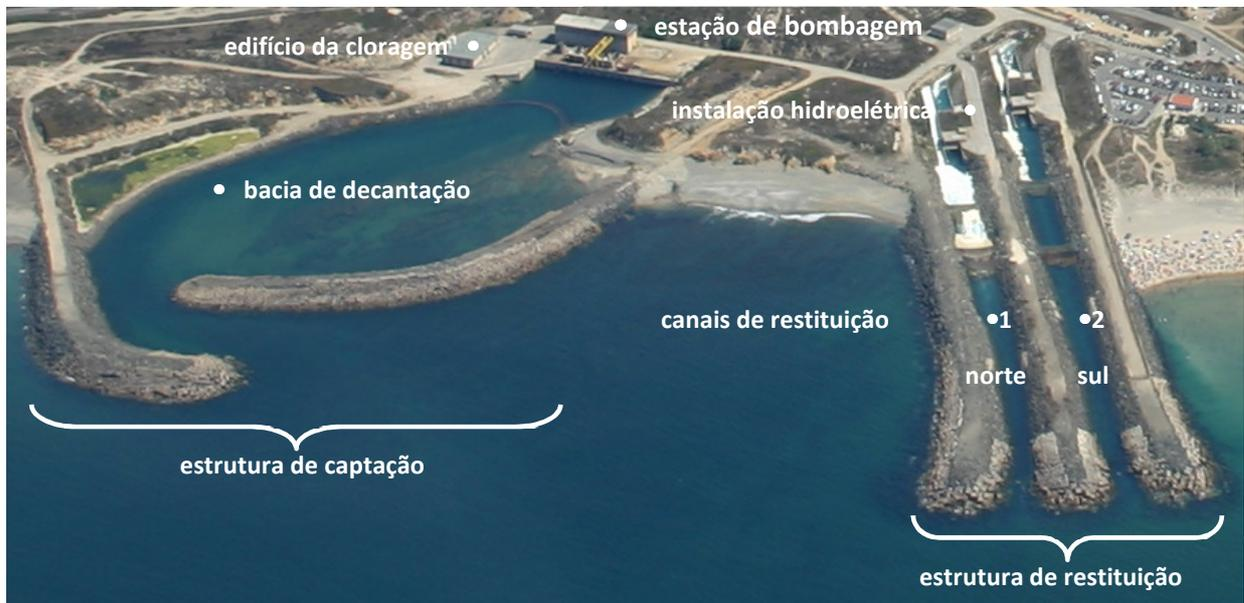
Figura 3 - Estruturas de captação e restituição/descarga do CAR
