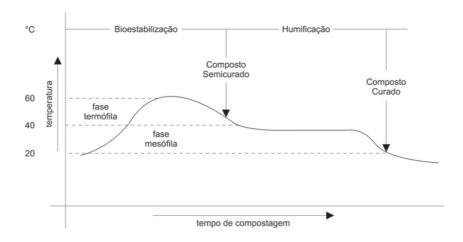
Dada a natureza e características dos resíduos "à entrada" das pilhas, estima-se uma perda, no produto final, após o processo de compostagem, na ordem dos 30 a 40 % (em massa), valor que se prende, principalmente, com a elevada percentagem de humidade nos resíduos processados e desidratação durante o processo, que se estima uma perca de 50% em humidade e do tempo de compostagem.
