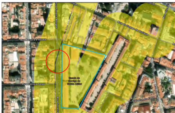
Local de interseção do túnel com troço do aqueduto (extraído de Atlas do Património - DGPC)
