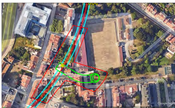
Localização (aproximada) da intersecção da ZEP com o futuro túnel e PV211, em ortofoto com implantação do projeto
