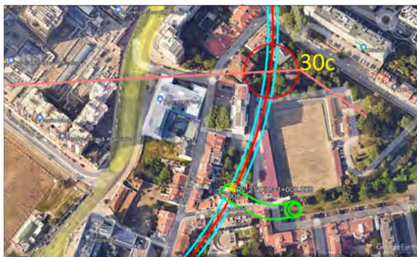
Local de interseção do EP (a rosa) com o futuro túnel, em ortofoto com implantação do projeto
