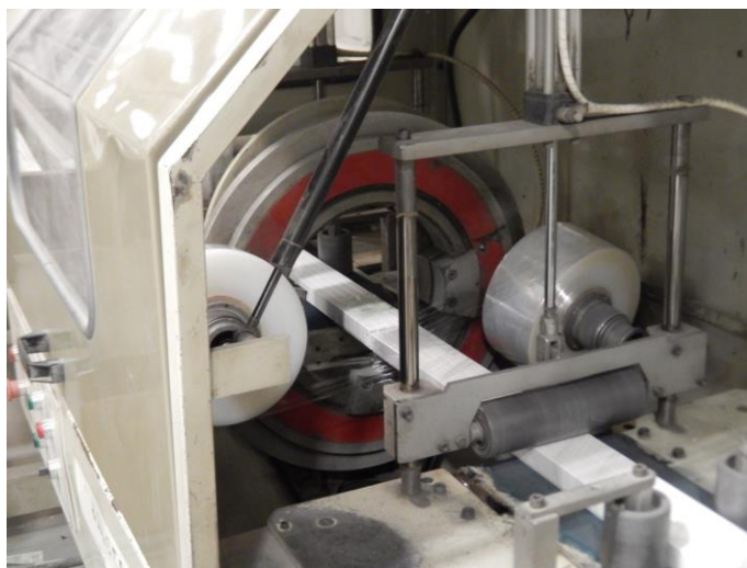
Figura 17 – Forno de Embalar peças tratadas (Lacagem)
