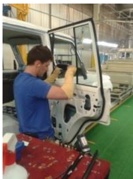
Figura 6 – Montagem de cabines
