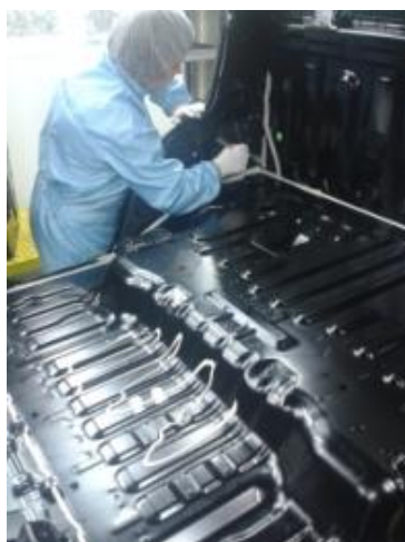
Figura 4 – Aplicação de vedantes e PVC
