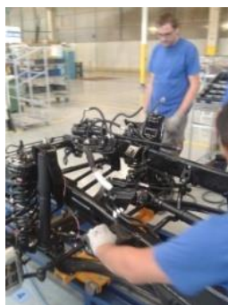
Figura 7 – Montagem de chassis
