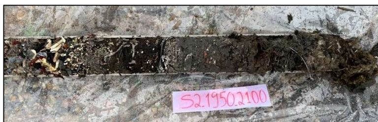
Figura 18. Pormenor de aterro heterogéneo: S2_1950_2100 – Aterro A, constituído por abundantes fragmentos de plástico, de madeira, de metal e fibras sintéticas.
