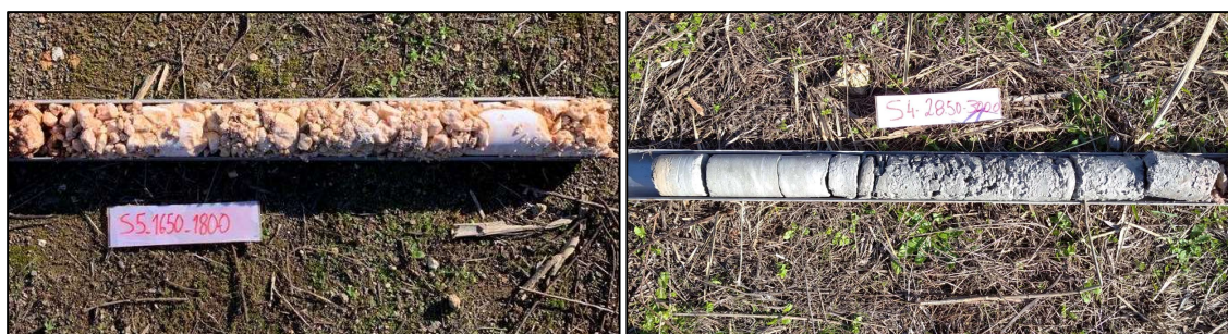
Figura 21. Pormenor dos diferentes calcários descritos (base da pedreira): S5_1650_1800 (esquerda) e S4_2850_3000 (direita).
