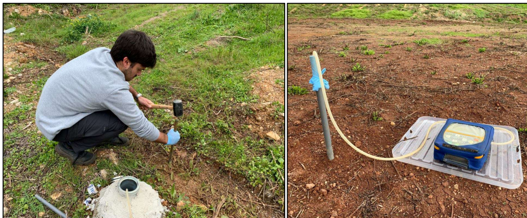
Figura 15. Realização do furo prévio (esquerda) e leitura de biogás nos furos superficiais (direita).
