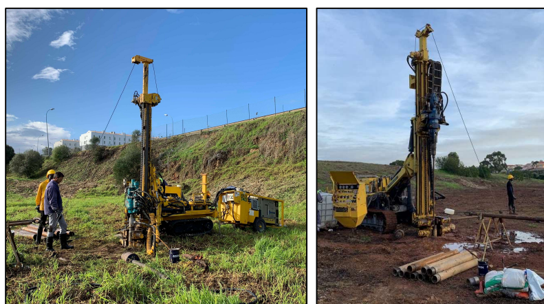
Figura 9. Sonda hidráulica modelo Beretta (esquerda) e Sonda hidráulica modelo Mustang 5-P4 (direita).
