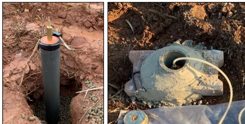
Figura 13. Sondagem S2 selada com rolha de borracha colocada (esquerda) e tampa de proteção (direita).
