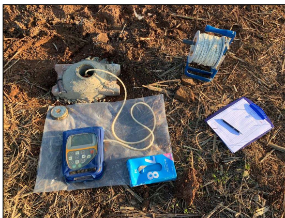
Figura 14. 2ª campanha de medição das concentrações de biogás – Leitura no furo S4.
